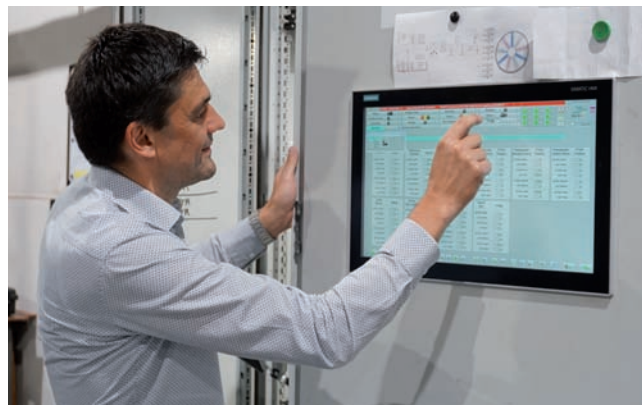
Na operátorskom paneli umiestnenom pri linke si obsluha môže zobrazit' obrazovky jednotlivých častí linky s aktuálnymi údajmi.
